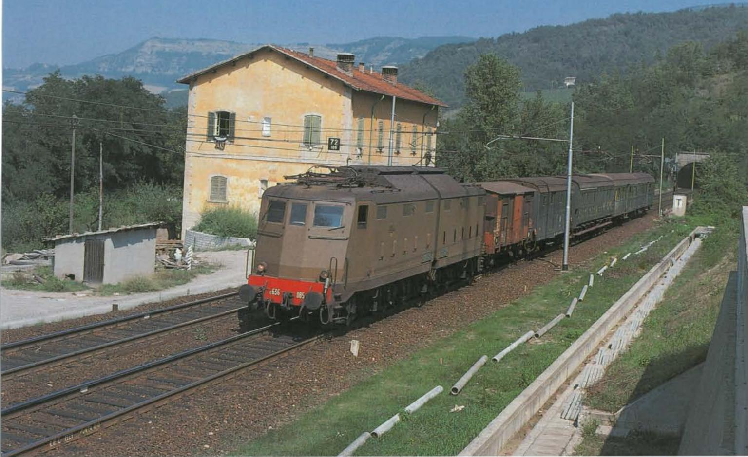
**Foto 3.6:** Sulla rampa settentrionale della Direttissima Appenninica, presso Monzuno-Vado. La locomotiva E.636.085 seguita da un carro merci, un bagagliaio a due assi, una vettura "Centoporte" ed una "Corbellini", disimpegna il locale 8097 Bologna-Firenze, il 12 settembre 1977.
