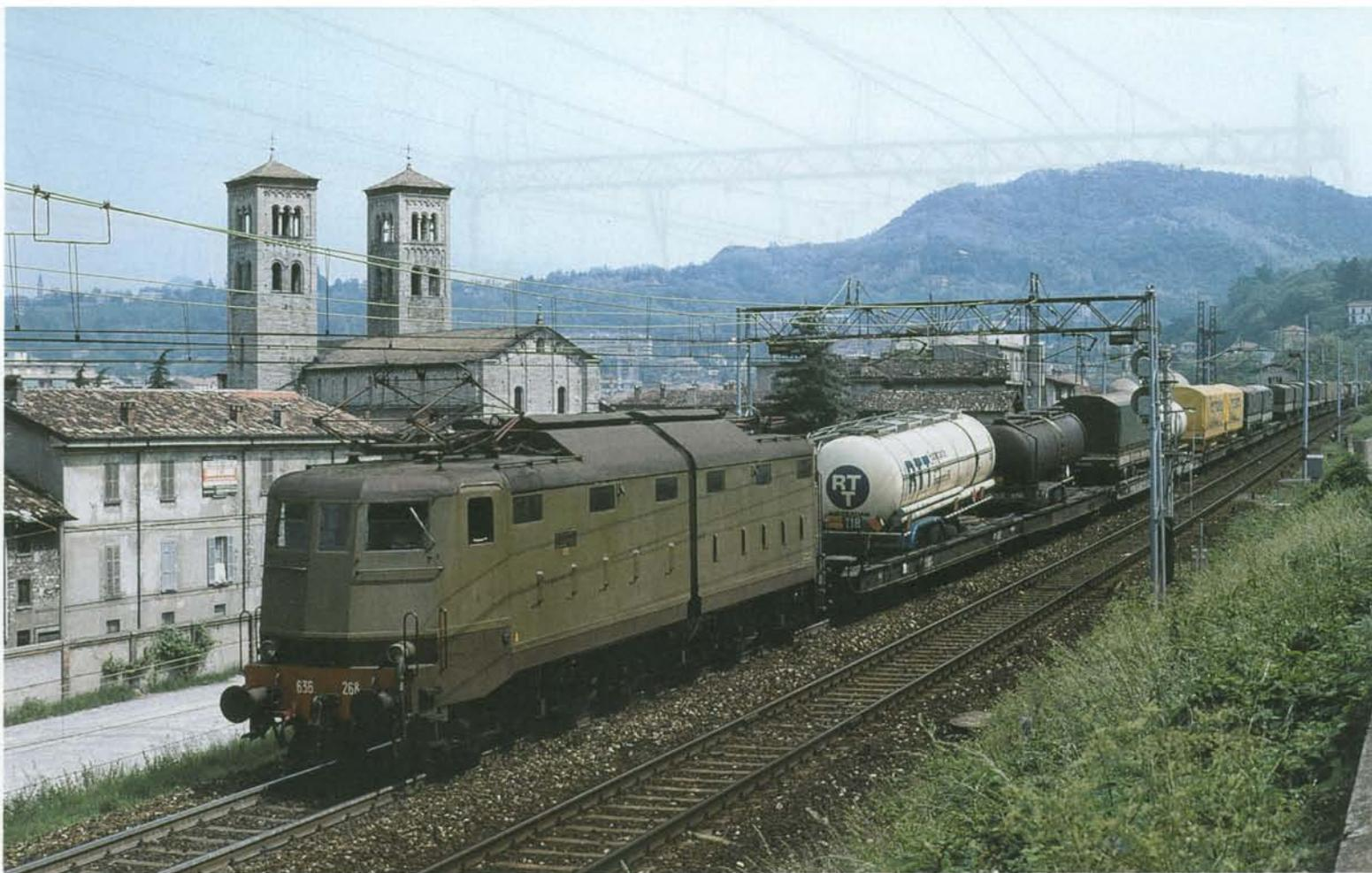
**Foto 3.49:** la linea Chiasso-Milano, anche se sulla carta lo sembra, non è del tutto pianeggiante, percorrendo discreti dislivelli. Da Chiasso (238 m) a Como (217 m) scende leggermente per poi risalire, in soli 5 km, ai 277 m di Albate/Camerlata. Per questo, sono previste anche delle doppie trazioni, come testimonia la E.636.268 della foto, provvista di maglia sganciabile, in spinta ad un merci ripreso nei pressi del Chostro di Sant'Abbondio, il primo giugno 1985.
